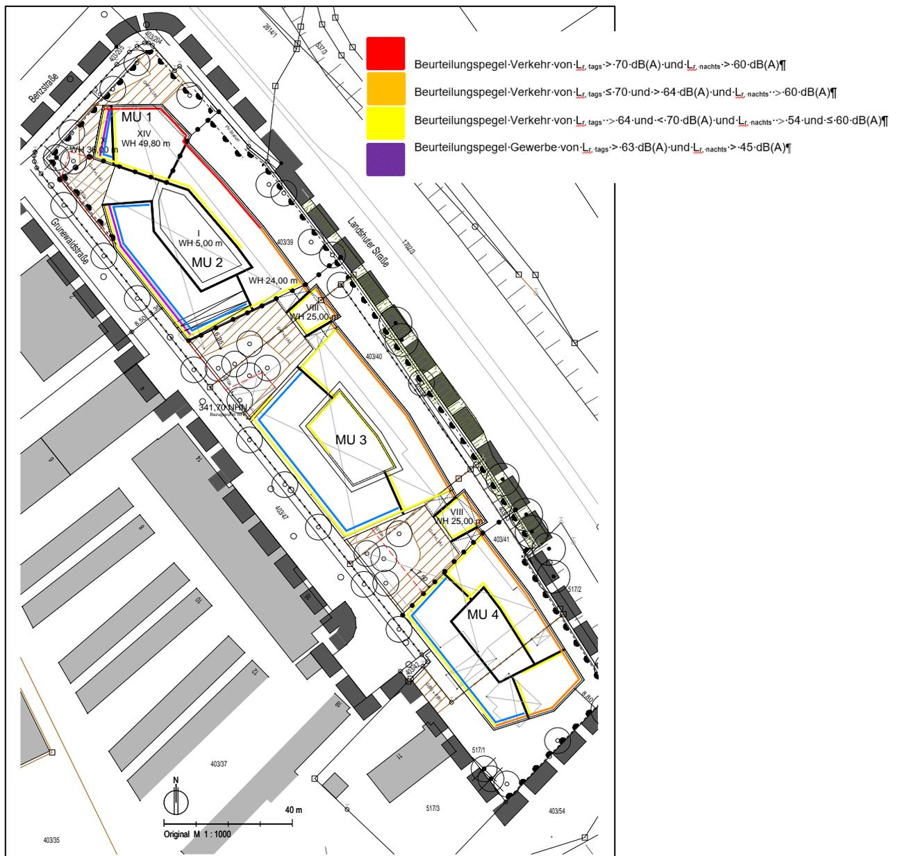
Abb. 10: Fassaden mit immissionsschützenden Maßnahmen (vgl. auch Anlage zur Satzung)
