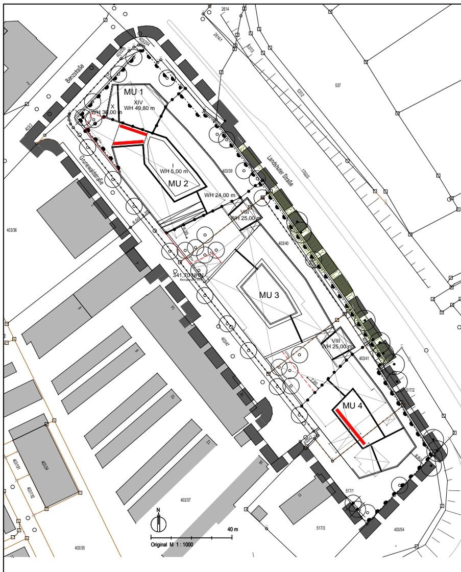
Abb. 8: Bereiche, in denen keine Belichtung unter  $45^\circ$  Lichteinfallswinkel möglich ist
